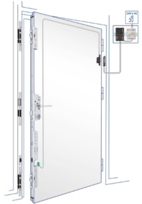
Steuerung und Netzteil zur Hutschienen-Montage im Schaltschrank
