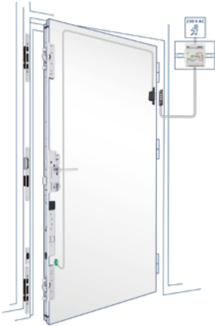
Netzteil zur Hutschienen-Montage plus Funkempfangsmodul
